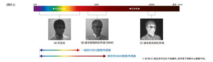
搭载SenSWIR™技术的图像传感器不仅可以拍摄SWIR波段的光,还能在包含可见光的400nm~1700nm的宽波段中成像。因此,一台相机就能发挥可 见光用途和SWIR用途二种作用,这不仅能扩大检测对象及应用范围,还能削减检测的系统成本,提高图像处理速度,从而提高总处理能力。另外还可 以避免多台相机造成的"画面错位",以像素单位的精度来进行对齐。
